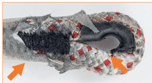
Terminaison cousue détériorée : cosse-cœur et gaine thermorétractable partiellement manquante, couture et longe usées, étiquette illisible.
