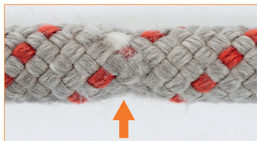
Cordino con anima danneggiata. Questo danno si rileva meglio al tatto anche se è possibile notare un leggero assottigliamento del cordino.
