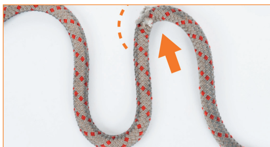
Schnur mit beschädigtem Mantel. Man bemerke den Unterschied in der Biegung zwischen intakter Stelle (reguläre Biegung, unten links) und beschädigter Stelle (unterbrochene Biegung, oben rechts).
