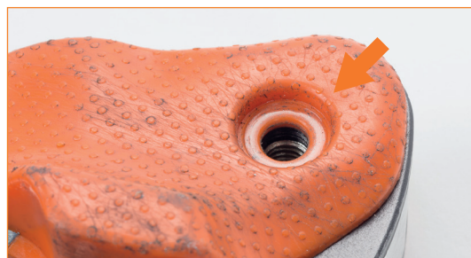
Regler mit fehlender Schraube.
