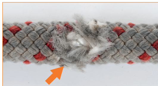
Longe dont la gaine est détériorée : l'âme de la corde est visible.
