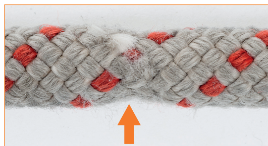
Longe dont l'âme est détériorée. Cette détérioration se détecte mieux au toucher, même s'il est possible, visuellement, d'observer que la longe est devenue plus fine.
