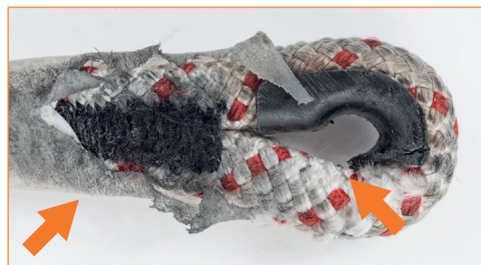
Asola terminale danneggiata: redancia e guaina termoretraibile parzialmente mancanti, cucitura e cordino usurati ed etichetta illeggibile.
