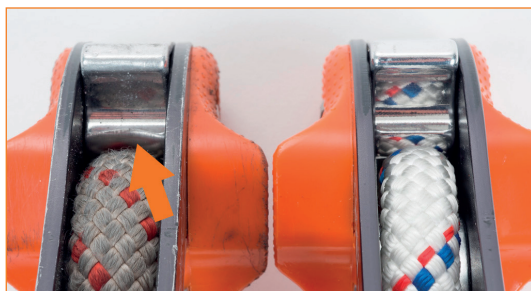
Came du tendeur très usée : on notera la différence entre un produit neuf (à droite) et un produit avec une came usée (à gauche).
