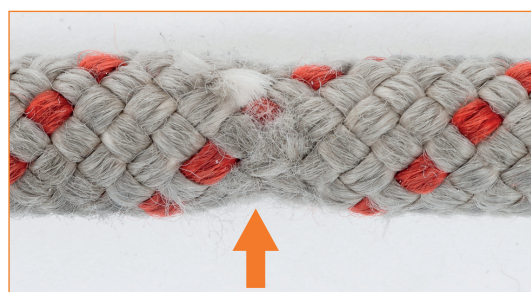
Cuerda con alma dañada. Este daño se detecta con más facilidad con el tacto pero es posible observar un leve adelgazamiento de la cuerda
