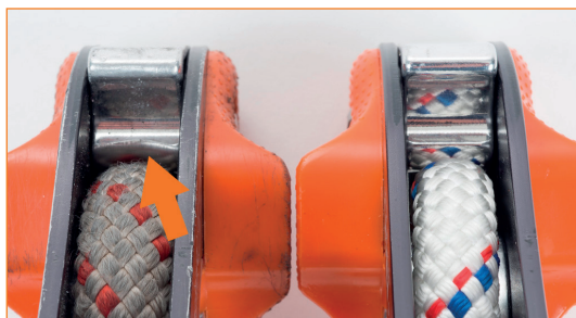
Leva del regulador muy desgastada: observar la diferencia entre un dispositivo nuevo (a la derecha) y aquello con leva desgastada (a la izquierda).
