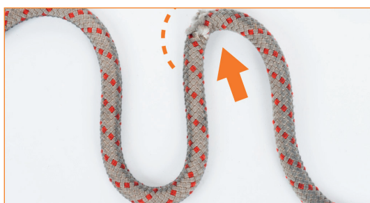
Cuerda con funda dañada. Observar la diferencia entre la curvatura de la zona intacta (curvatura regular, abajo a la izquierda) y la curvatura de la zona dañada (curvatura no regular, partida, arriba a la derecha).
