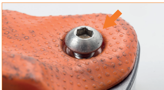
Dispositivo de regulación con tornillo suelto. 🔧 Añadir un poco de fijador de roscas de baja resistencia y atornillar hasta completamente apretado.
