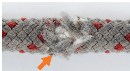
Cuerda con funda dañada: el alma de la cuerda queda a la vista.
