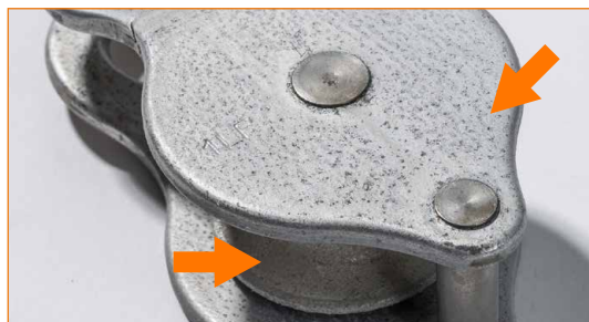
Cuerpo y roldana completamente oxidados.
