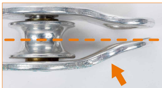
Cuerpo deformado cerca de los orificios de enganche.
