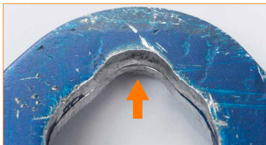
Runko, jonka kiinnitysaukkojen vieressä on huomattavia kulumisen merkkejä.
