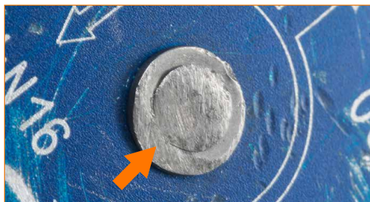
Runko, jonka akselin vieressä on selkeitä kulumisen merkkejä.
