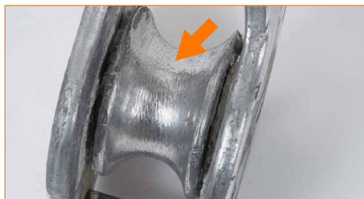
Roldana desgastada en un solo punto por el deslizamiento de un cable metálico por encima de la roldana bloqueada.
